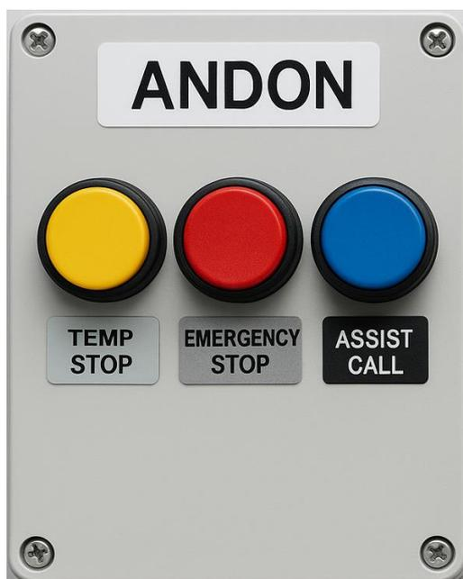
Рисунок 2.3 – Элемент системы визуального контроля Andon на производственной линии: кнопки TEMP STOP, EMERGENCY STOP и ASSIST CALL
